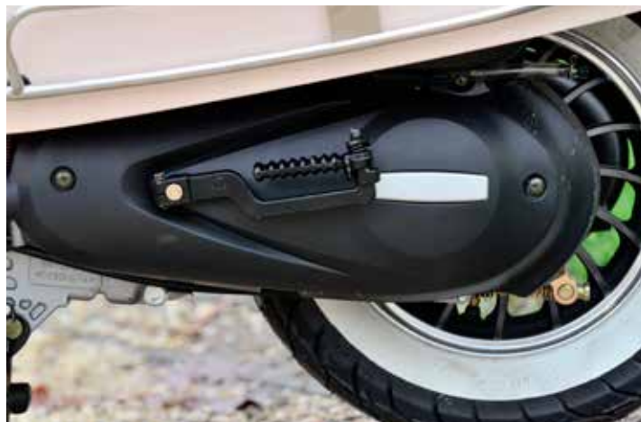
Het carter is netjes afgedekt met deze cover
