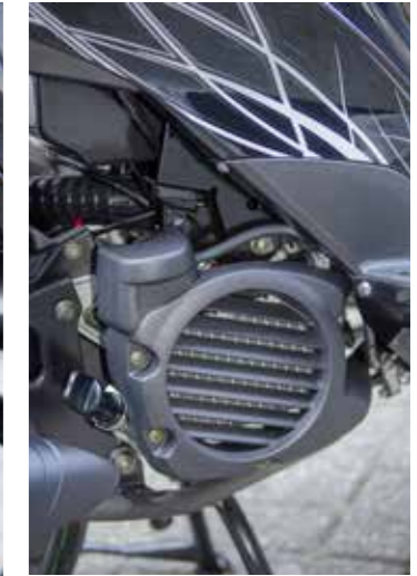
De radiator zit aan de rechterzijde van het motorblok gemonteerd
