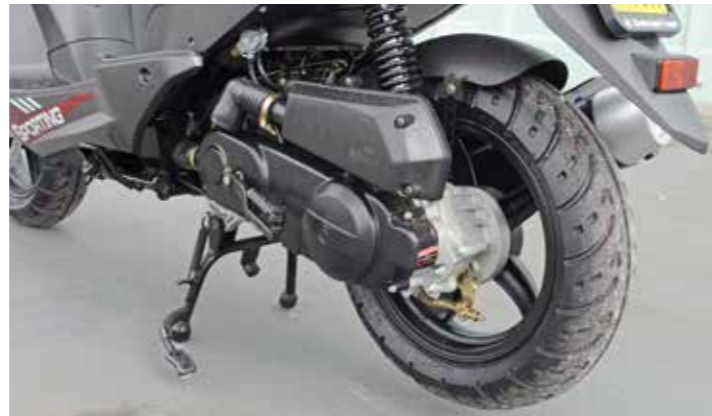
Luchtgekoelde 4-takt met carburateur
