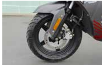
Een prima werkende schijfrem op het 12 inch voorwiel
