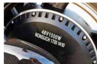
Een krachtige 1.500 Watt sterke naafmotor
