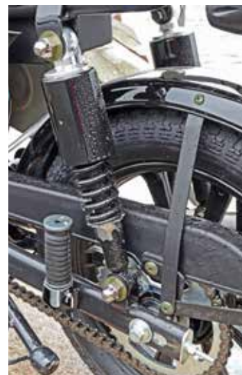
De schokdempers achter zijn zelfs verstelbaar
