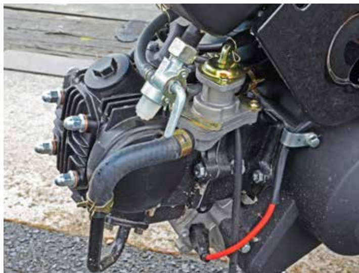
Het 4-takt motortje is een kloon van de bekende 4-takt Honda motor dus onverslijtbaar
