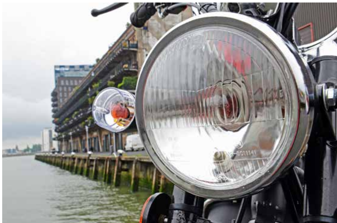
Een traditionele ronde koplamp zoals we die kennen, maar de Boxer is ook voorzien van richtingaanwijzers
